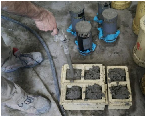
Figura 3.6 - Vibração do betão
