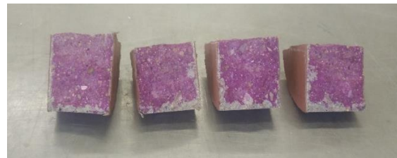
Figura 3.25 - Identificação da frente de carbonatação
