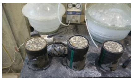
Figura 3.21 - Colocação dos provetes dentro de mangas de borracha
