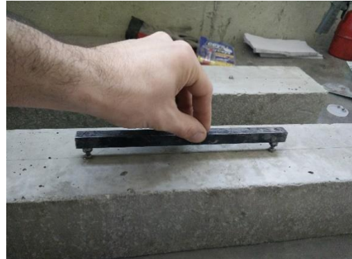
Figura 3.15 - Definição da distância entre as pastilhas metálicas com o auxílio da barra padrão
