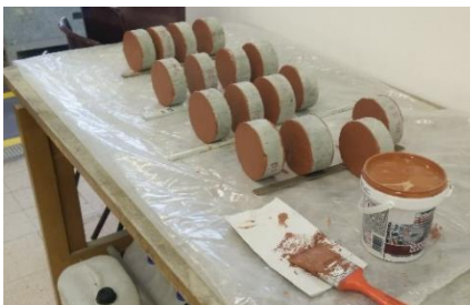
Figura 3.24 - Aplicação de uma película de borracha líquida isolante nas faces superior e inferior dos provetes
