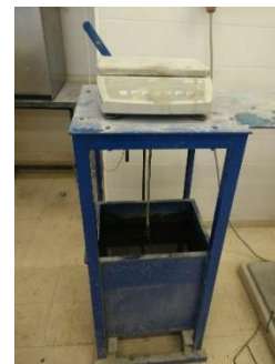
Figura 3.17 - Determinação da massa hidrostática do provete
