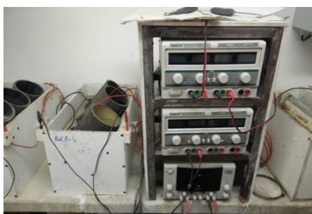
Figura 3.22 - Ligação da fonte de alimentação ao reservatório plástico que contém os provetes
