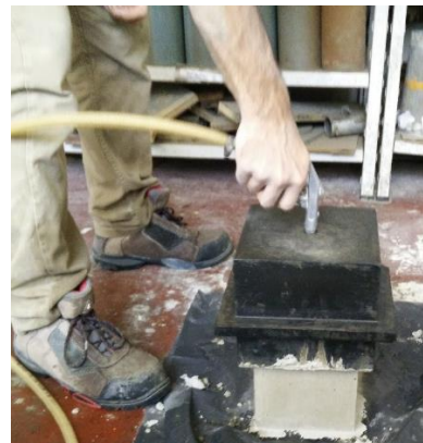
Figura 3.7 - Descofragem dos moldes
