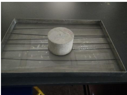
Figura 3.18 - Enchimento do tabuleiro com água até uma altura de 5 \pm 1 mm em relação à face do provete em contacto com a água
