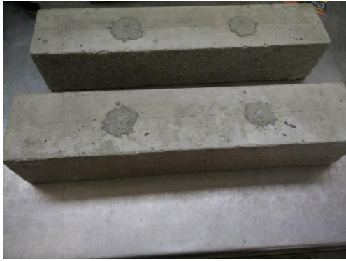
Figura 3.14 - Colagem das pastilhas metálicas
