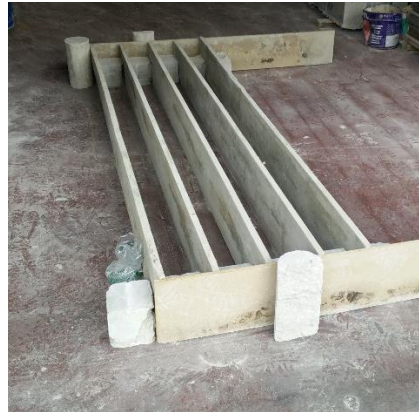
Figura 3.5 - Cofragem dos betões de referência
